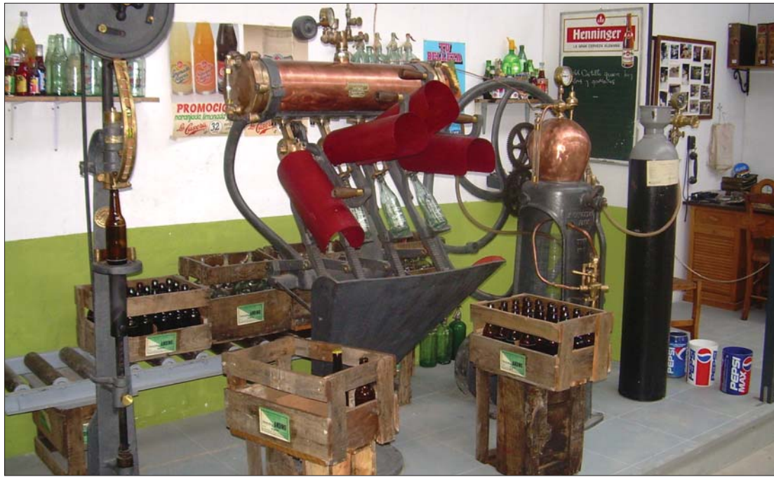
► De drcha a izqd, botella de anhídrido carbónico. saturadora llenadora y taponadora de gaseosas
