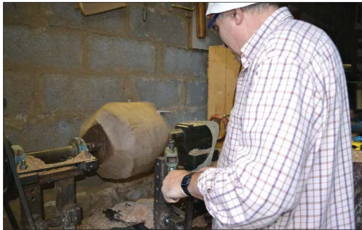
Jesús pone el taco de madera y comienza a trabajar con el torno.
