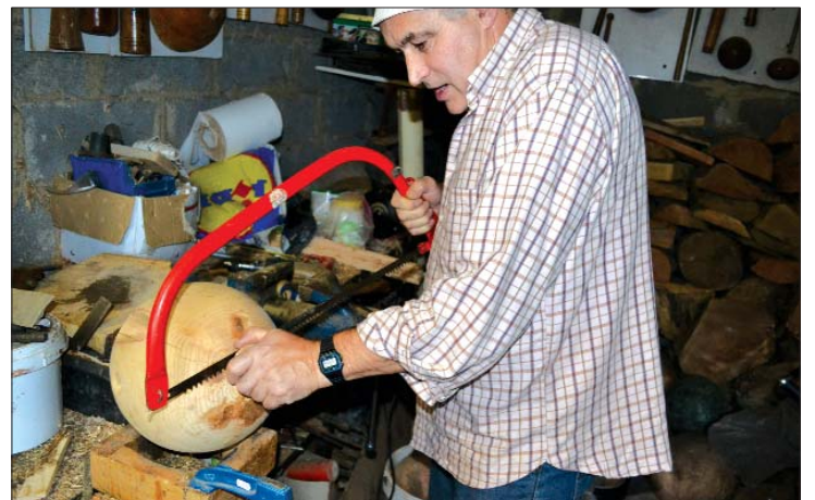
Para finalizar se sierran los soportes para torno.
