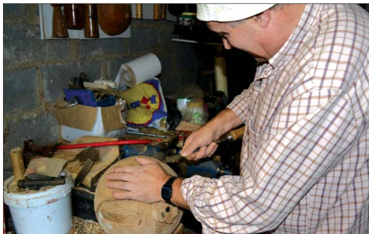
La agarradera se hace de forma manual con un cincel y un martillo
